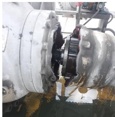
شکل ۱: پوسته گیربکس تیکنر باطله دچار آسیب
