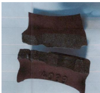
شکل ۴: سطح شکست پوسته گیربکس
