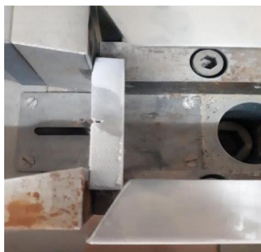
شکل ۲: انجام آزمون ضربه Charpy V-notch بر روی نمونه های به ابعاد 10 \times 10 میلی متر در دمای 20^\circ\text{C} - درجه سانتی گراد
