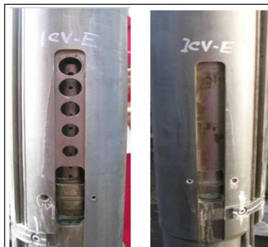
شکل ۱۲: شیر کنترل درون چاهی در حالت بسته (سمت راست) و حالت کاملاً باز (سمت چپ)
