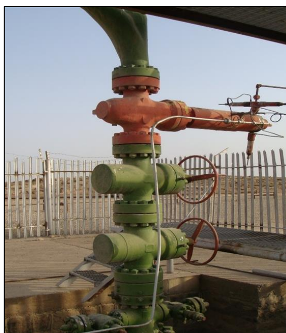
شکل ۸: موقعیت قرارگیری شیر ایمنی سرچاهی بر روی تاج چاه
