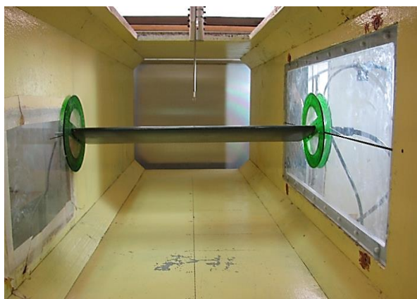
شکل ۵: نمایی از مقطع بال نصب شده و حسگر سیم داغ درون محفظه آزمون
