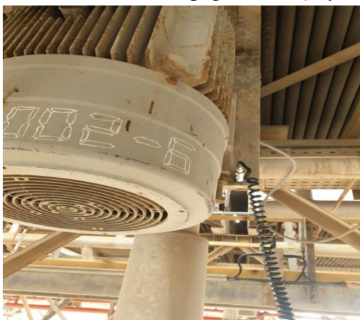
شکل ۳. نمایش محل اندازه گیری ارتعاش
