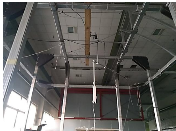
شکل ۵: حسگر در پیچه هلمهولتز و در حال داده برداری
